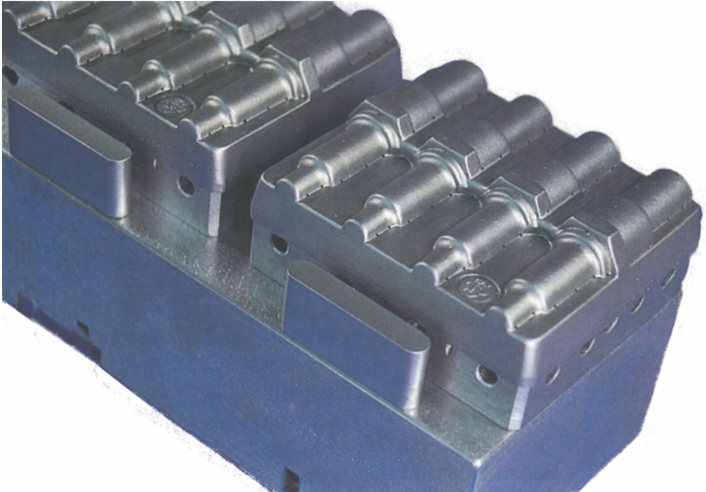
Positivform til fremstilling af tændrørs-emballage
